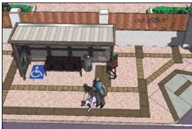
Figura 2. Modelo de instalação de mobiliário urbano.
