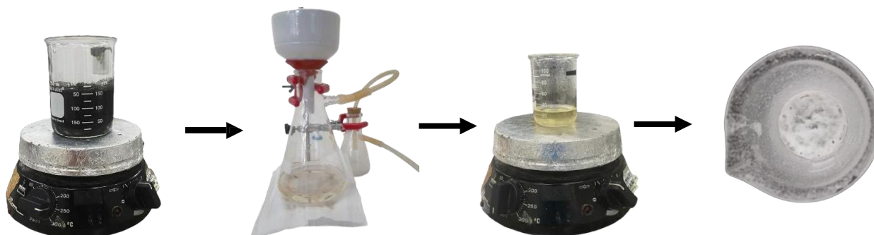
Figura 4 - Sequência metodológica de secagem, trituração e formação das cinzas.
