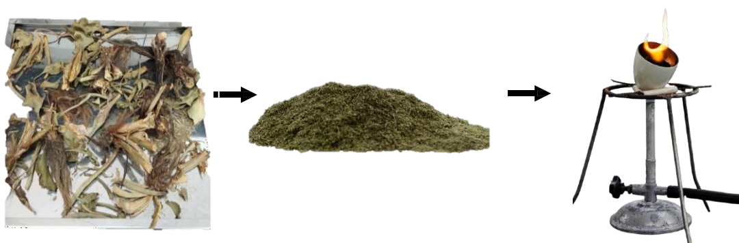
Figura 3 - Sequência metodológica de secagem, trituração e formação das cinzas.
