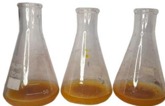
Figura 5 - Erlenmeyers contendo amostras durante o ponto de viragem da titulação de Mohr.
