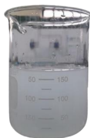
Figura 6 - Precipitado formado durante a determinação gravimétrica de potássio.
